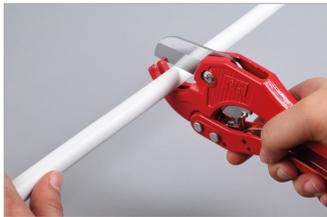
Tagliare il tubo perpendicolarmente al proprio asse, utilizzando una cesoia, (si consiglia di ruotare leggermente la cesoia durante l'operazione), oppure la tagliatubi a rotella, al fine di limitare l'ovalizzazione del tubo stesso.
