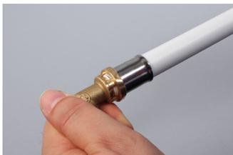
Inserire il tubo a fondo nel raccordo; la corretta posizione di accoppiamento è segnalata dalla visibilità della tubazione attraverso le fessure dell'anello ferma bussola. La forma a terminale svasato della bussola, inoltre, facilita l'inserimento del tubo.
