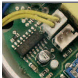
Versione HT con circuito elettronico a microprocessore
