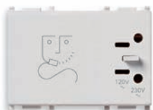
14290 (.SL) 230 V~ 50-60 Hz, con trasformatore di isolamento 20 VA, uscite 230 V~ e 120 V~ - 3 moduli
