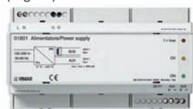
01801 Alimentatore con uscita 29 V d.c. 800 mA, 120-230 V~ 50-60 Hz
