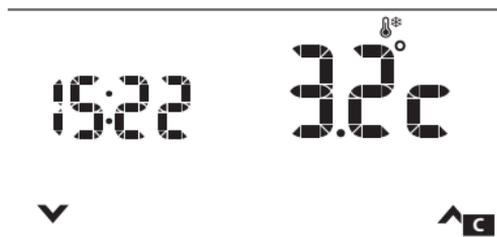
Quando l'impianto viene messo in modalità antigelo **C** (🧊) le frecce permettono di impostare la temperatura ambientale minima tollerata; Successivamente riapparirà la temperatura rilevata.
