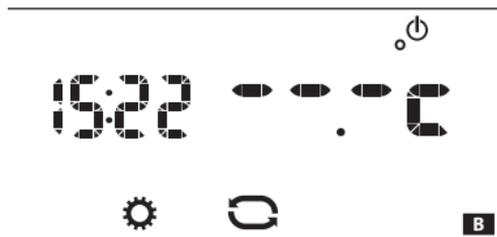
Quando l'impianto viene spento (⏻), per alcuni secondi sullo schermo viene visualizzata l'immagine della figura **B** ad indicare che il cronotermostato è spento; Successivamente riapparirà la temperatura rilevata.
