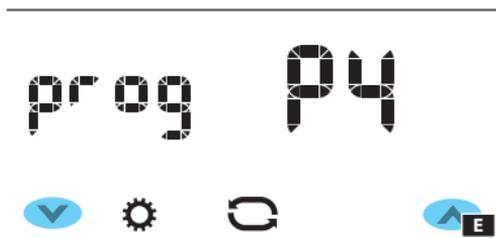
Premere il pulsante
