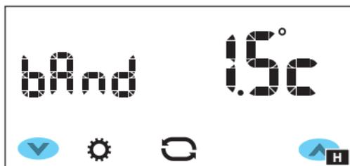
Premere il pulsante
