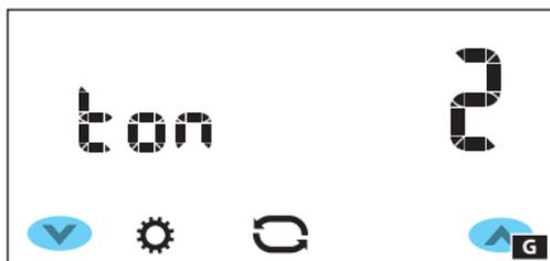
Premere il pulsante
