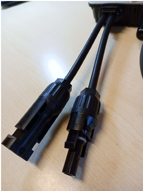
Connettori tipo MC4 (input DC) per collegamento pannello fotovoltaico a micro inverter
