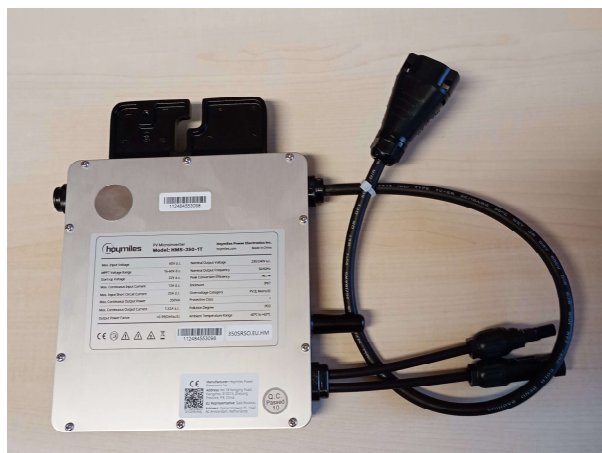
Micro inverter – taglie 350VA oppure 700VA
