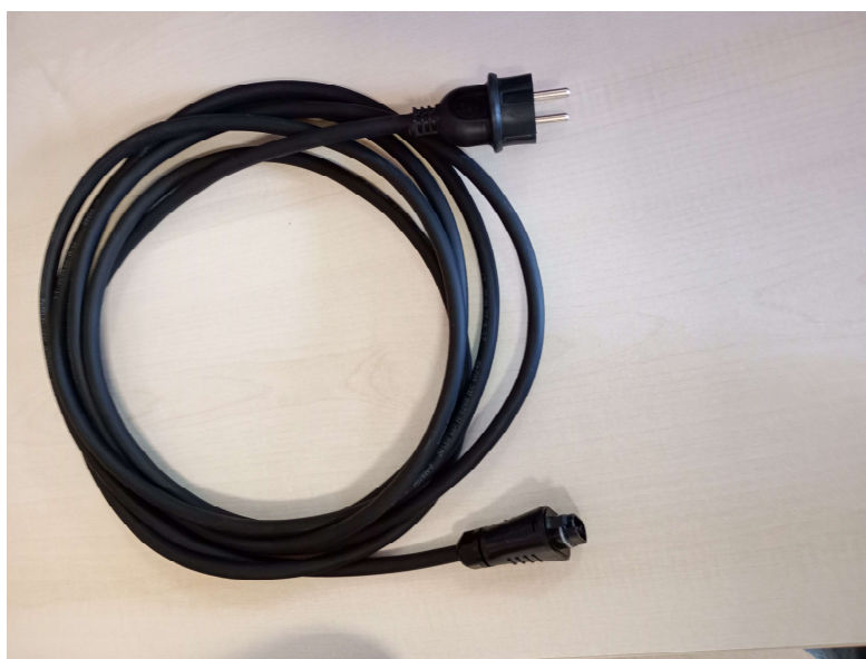
Cavo di collegamento Inverter presa dedicata – lunghezza 3 o 5 metri cavo tipo H07RN-F 3x1,5 mm 2 - con Spina tipo Scuko e connettore femmina allaccio inverter
