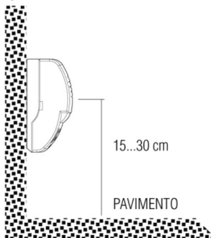
Il GPL è più pesante dell'aria e si stratifica nei punti più bassi del locale. Le maggiori concentrazioni si hanno a livello del pavimento. Il rivelatore deve essere montato con l'asse centrale perpendicolare alla griglia, a  $\cong 30$  cm dal piano di calpestio più basso.
