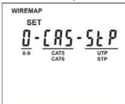
4. Premere il tasto SET/UNIT. Il parametro "0" lampeggia a display. Questo parametro consente di selezionare una delle configurazioni numeriche da 0 a 9 salvate dall'utente in base al tipo e alla eventuale alla calibrazione della lunghezza del cavo
