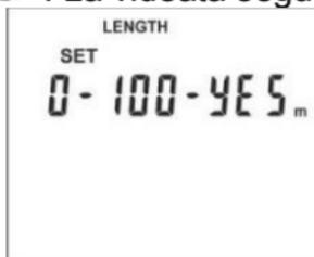
4. Premere SET/UNIT per selezionare il marcatore da 0-9 e ancora SET/UNIT per impostare la lunghezza 10 ÷ 250 (unità m) oppure 30 ÷ 750 (unità ft). Il valore lampeggia a
