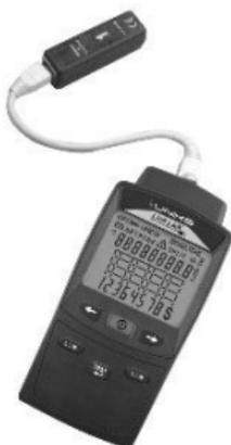
5. Premere il tasto
