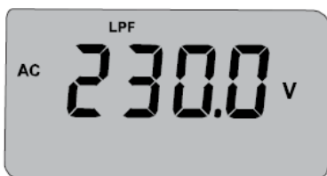
Fig 8.2 Modalità filtro passa basso
