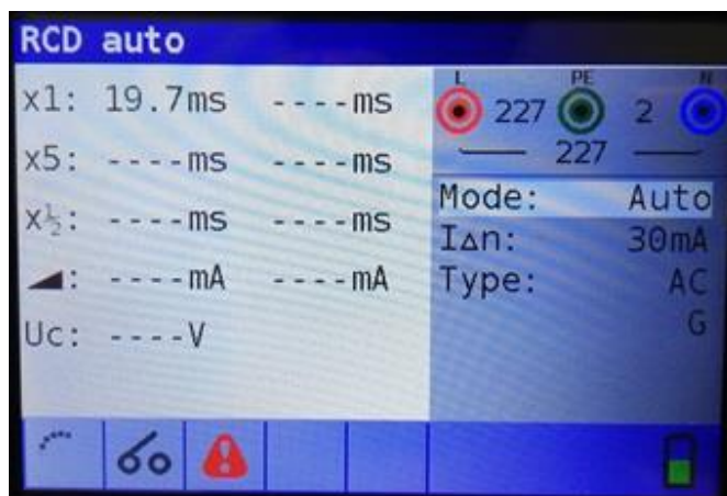
Figura 5-20 dell'autotest RCD Step 1
