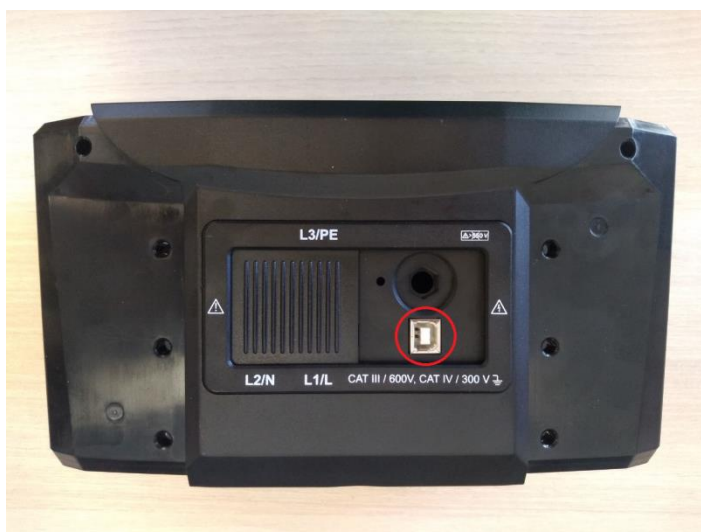
Figura 9.2: Il connettore USB si trova sul lato superiore dell'alloggiamento dello strumento
