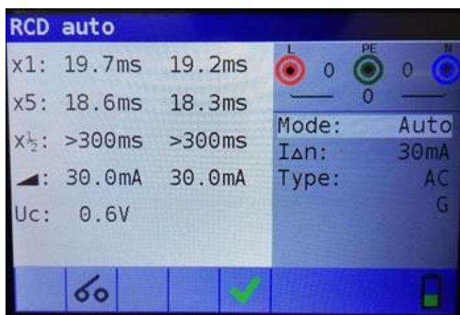
Figura 5-27 Risultati del test automatico RCD Step 8
