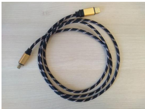
Figura 9.3: Cavo di collegamento USB(tipo A-male a B-maschio)
