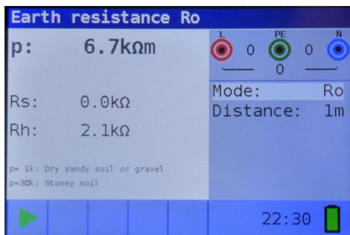
Figura 5-52: Esempio di risultati specifici della misura di resistività del terreno
