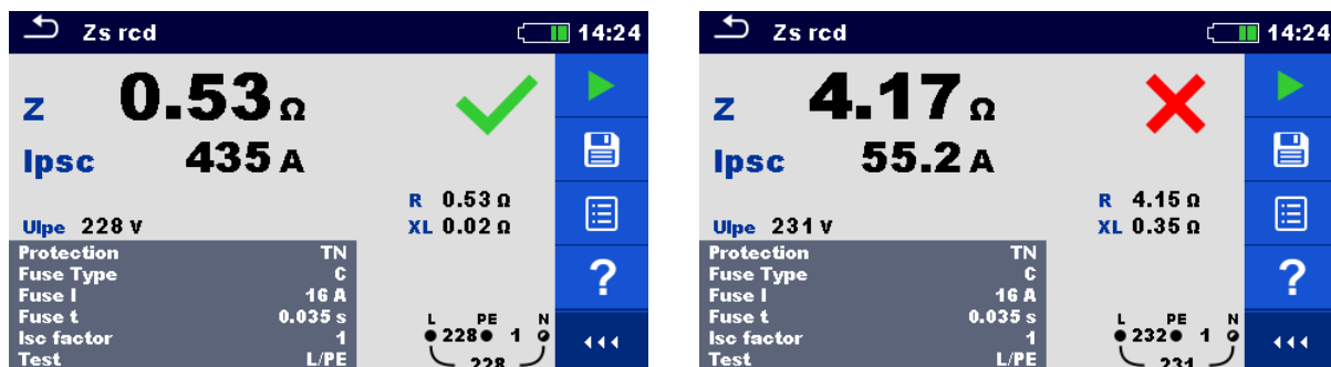
figura 7.31: Esempi di Zs risultato della misurazione rcd
