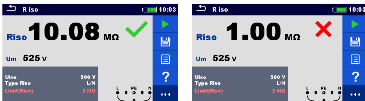
figura 7.8: Esempi di risultati della misura d'isolamento
