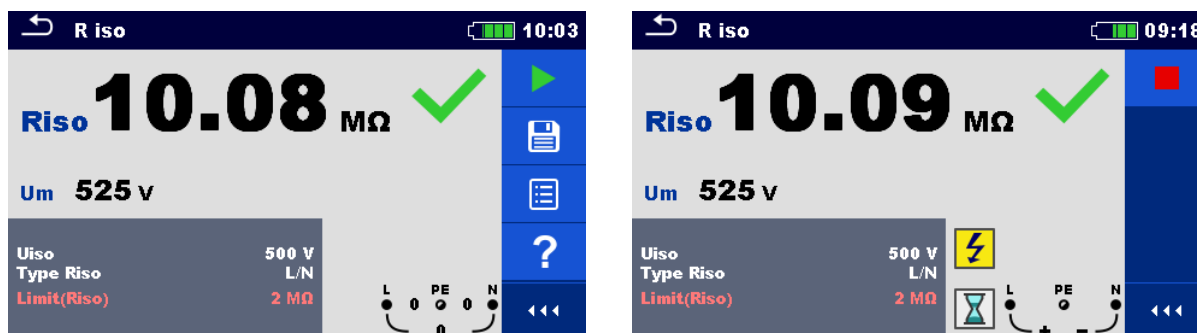
figura 6.1: Organizzazione schermata di test singolo, esempio di misura della resistenza di isolamento
