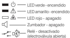
Fig. 2 - Estado "funcionamiento no Operativo"
