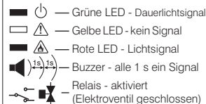
Abb. 5 - Zustand "Gasalarm" und Relaisaktivierung
