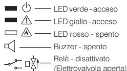
Fig. 2 - Stato operativo "funzionamento non operativo"
