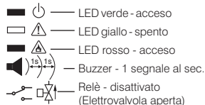
Fig. 4 - Stato di "allarme presenza gas"
