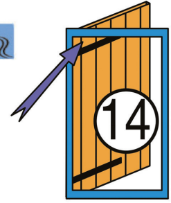
Montaggio architrave Persiana sinistra Uscita cavo sinistra
