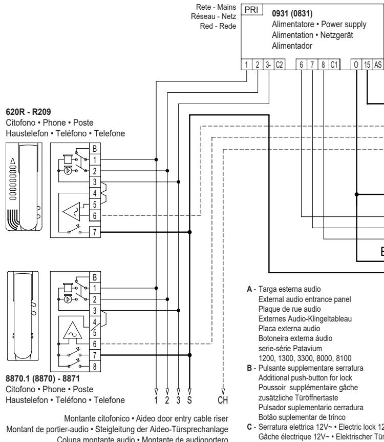
**Sezione condutri - Conductor section
