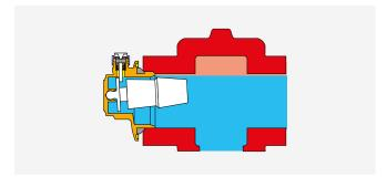
▲ AVVERTENZA. Chiudere il tappo della valvola di sfogo aria durante le operazioni di lavaggio e di riempimento dell'impianto, per evitare che le impurità entrino nei meccanismi della valvola danneggiandola.
