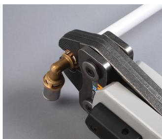
Per la pressatura dei raccordi utilizzare una ganaschia della misura corrispondente a quella del raccordo e con profilo secondo la tabella "Profili pinze utilizzabili" a pagina 2:
