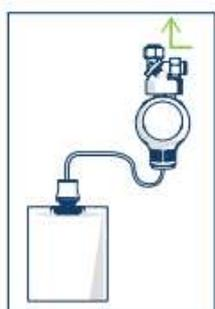
Dopo l'installazione dell'apparecchiatura, a seconda dello spazio utile disponibile, si può decidere di agganciare la ricarica di AcquaSIL 2/15® direttamente al corpo pompa MiniDUE (schemi in alto) o in versione remotizzata (schema a sx.).
