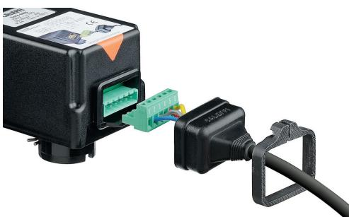
Die elektrische Verbindung des Motors erfolgt durch ein externes System Steckdose/Stecker, ohne die Abdeckung entfernen zu müssen. Nach dem Einsticken des Steckers die Schutzkappe aus Gummi in ihren Sitz, d.h. in die entsprechende Nut im Deckel, gleiten lassen. Danach muss die Schutzkappe wie in dem Bild befestigt werden und mit Schraubenzieher angezogen werden.
