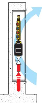
Pour empêcher que des températures élevées soient atteintes où la vanne de zone est installée, une aération constante est nécessaire.
