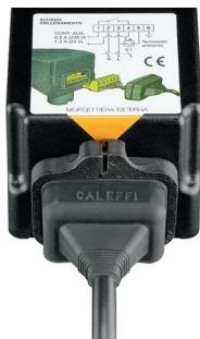
La conexión eléctrica del motorreductor se realiza con un sistema toma-clavija, exterior, que no requiere la apertura de la tapa. Con la clavija conectada, deslice la tuerca de protección en caucho, insertándola en el asiento en la ranura correspondiente de la tapa sucesivamente fijar la protección con la banda estrecha en dotación y, como en la imagen, apretar con un destornillador. Los siguientes esquemas ilustran las conexiones eléctricas normalmente adoptadas:
