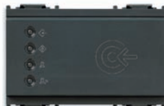
16926 (.B) Lettore carta transponder esterna alla stanza, standard KNX EIB, 2 IN, 2 OUT relè NO 2 A 24 V~ - 3 moduli
