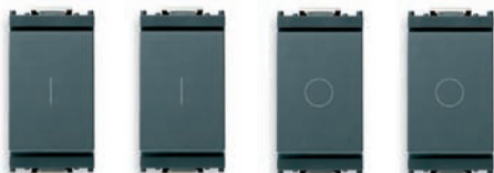
16101 (.B) 1P NO 16 A, (marcia) 16107 (.B) 1P NO 16 A, (marcia), contatto ausiliario 16104 (.B) 1P NC 16 A, (arresto) 16110 (.B) 1P NC 16 A, (arresto), contatto ausiliario
